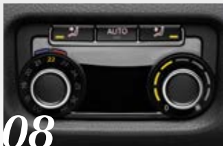
Manöverpanel bak för klimatanläggningen
