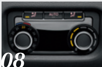
Manöverpanel bak för klimatanläggningen
