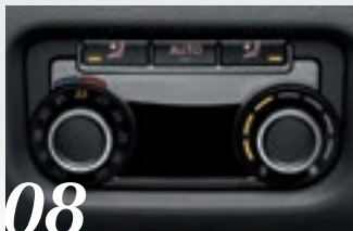
Manöverpanel bak för klimatanläggningen
