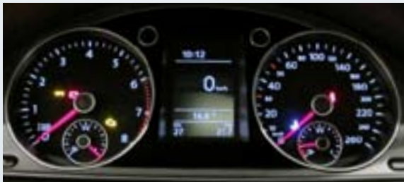
Kombiinstrumentet har dubbla tankmätare.
