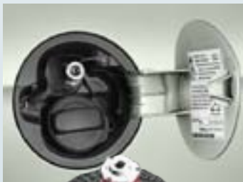
Ett gemensamt tanklock för bensin/fordonsgas.
