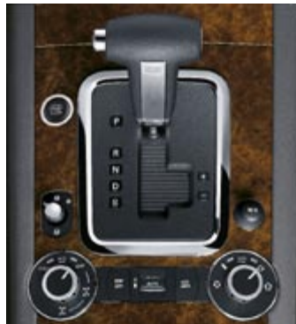
6-växlad automatlåda med Tiptronicfunktion.
