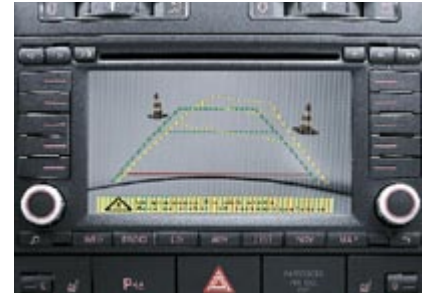
Parkeringsensorer med backkamera.
