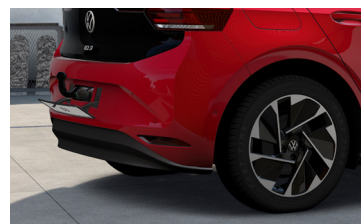
Cykelhållarfäste, avtagbart, monterat bakom registreringsskylten bak.
