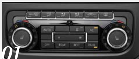
3-zons klimatanläggning, Climatonic
