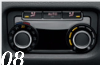
Manöverpanel bak för klimatanläggningen
