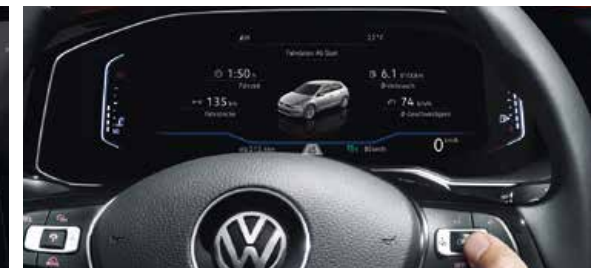
ACTIVE INFODISPLAY | T Med Active Info Display visas den viktigaste informationen digitalt på en högupplöst 12,3-tums skärm. Förutom varvräknare och hastighetsmätare kan du få informationen du behöver presenterad på olika sätt. Väljer du Navigation flyttas hastighetsmätaren och varvräknaren ut mot sidorna för att ge plats för kartan i mitten.
