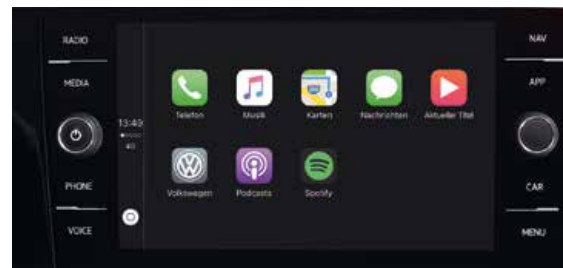
APP-CONNECT | T App-Connect gör det möjligt att via USB-kabel ansluta Apple- och Android-smartphones till bilens infotainmentsystem. App-Connect innehåller gränssnittet MirrorLink™.
