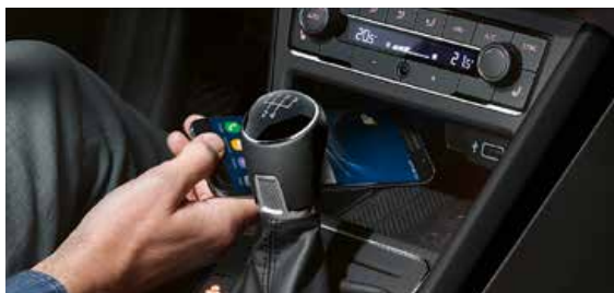
INDUKTIV LADDNINGSFUNKTION | T Placera bara din mobiltelefon i det främre förvaringsfacket, där den laddas upp induktivt. En förutsättning är att din mobiltelefon stöds av Qi-standarden.
