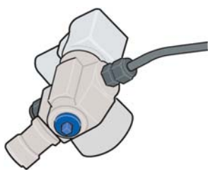
manueller Absperrhahn am Fuß des Flaschenventils.
