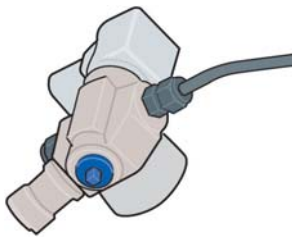
manueller Absperrhahn am Fuß des Flaschenventils.
