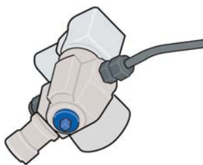
manueller Absperrhahn am Fuß des Flaschenventils.
