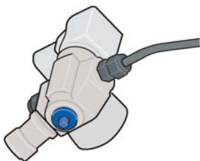
manueller Absperrhahn am Fuß des Flaschenventils.
