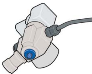
manueller Absperrhahn am Fuß des Flaschenventils.
