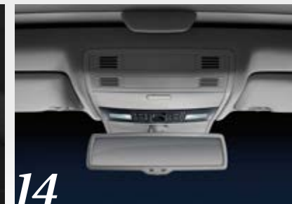
Stöldskyddslarm med kupéövervakning och nivåsensor
