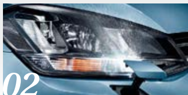
Halogenstrålkastare med högtrycksspölning
