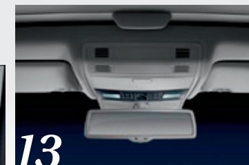
Stölskyddslarm med kupéövervakning och nivåsensor
